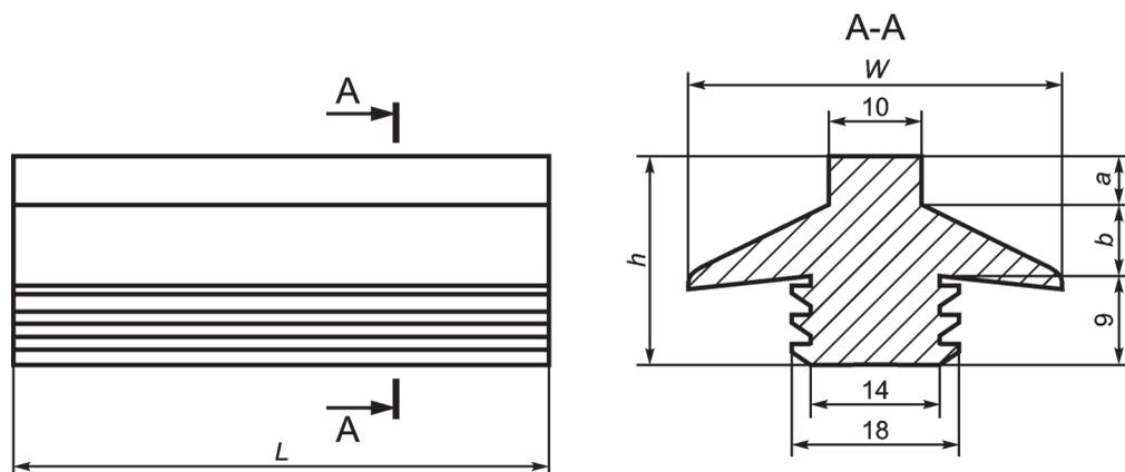
$L$  — длина упора;  $W$  — ширина упора по опорным планкам;  $a$  — высота упорного буртика;  $b$  — высота опорных планок;  $h$  — высота упора
