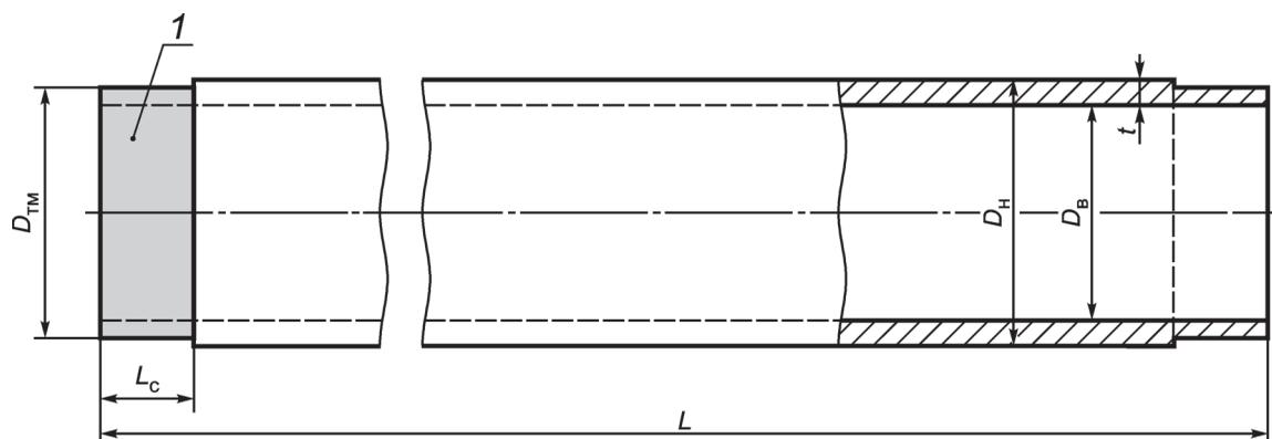
1 — калиброванная часть трубы для установки муфты;  $D_H$  — наружный диаметр;  $t$  — толщина стенки;  $L$  — длина трубы;  $D_{ТМ}$  — диаметр под муфтовое соединение (диаметр калиброванной части трубы);  $D_B$  — внутренний диаметр;  $L_c$  — длина соединения (длина калиброванной части трубы под муфтовое соединение)
