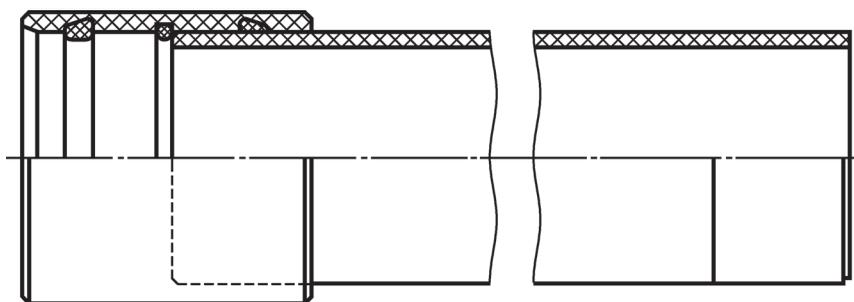
Рисунок 7 — Комплектация трубы с муфтой на уплотнителях
