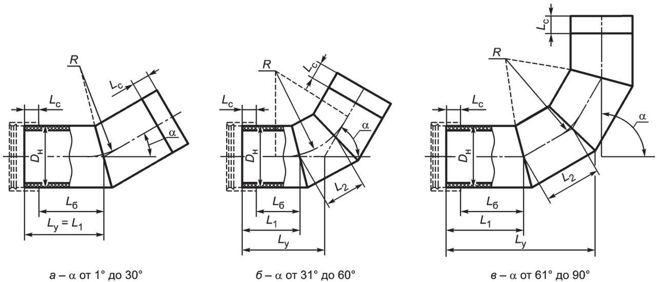
$D_H$  — наружный диаметр;  $\alpha$  — угол отвода;  $L_c$  — базовая длина отвода;  $L_y$  — уложенная длина отвода;  $L_1$  — длина концевых сегментов;  $L_2$  — длина промежуточных сегментов;  $L_c$  — длина частей труб отвода под соединение (длина соединения);  $R$  — радиус отвода
