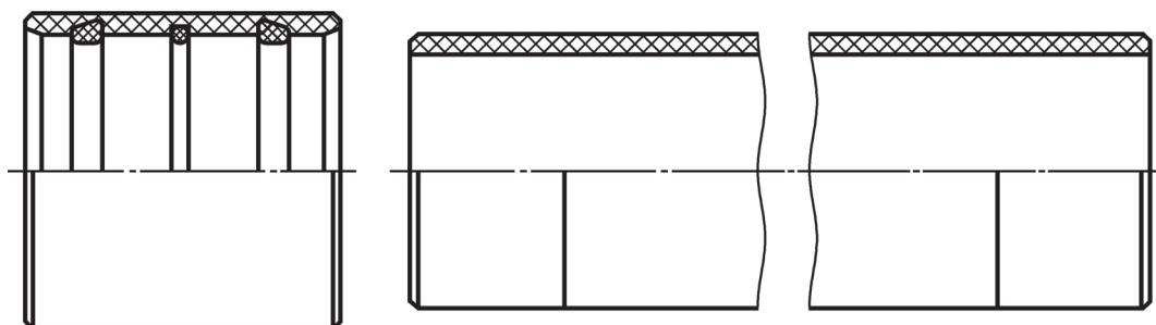
Рисунок 8 — Раздельная комплектация труб и муфт
