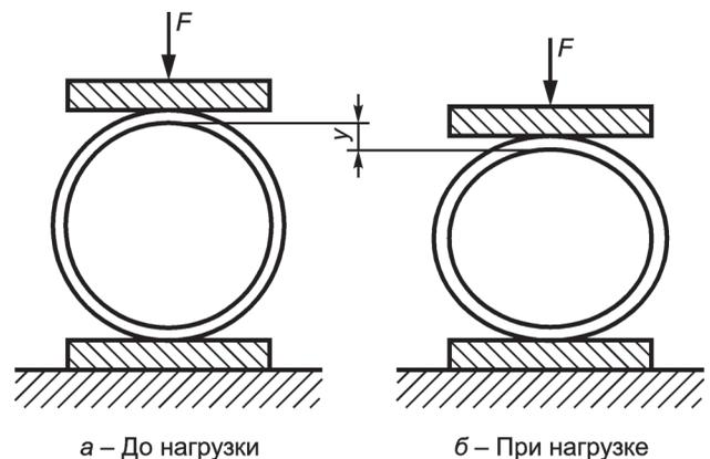
$F$  — приложенная нагрузка;  $y$  — деформация трубы
