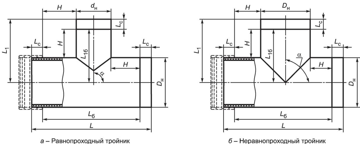
$D_n$  — наружный диаметр тройника;  $H$  — длина ламинируемой части;  $L_c$  — длина соединения;  $L$  — уложенная длина по основной трубе;  $L_1$  — уложенная длина по патрубку ответвления;  $d_n$  — наружный диаметр патрубка ответвления
